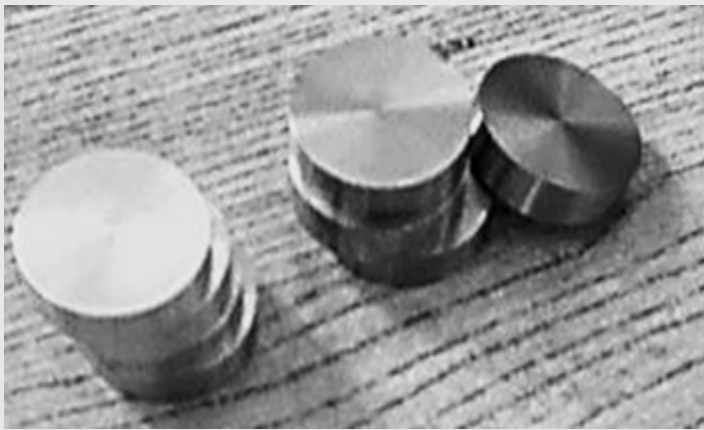
Figura. 2. Insertos de refuerzo de aluminio y acero inoxidable (lado derecho e izquierdo respectivamente).
